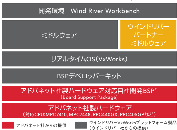
図2：VxWorksに対応したBSPまで自社で用意することで、アドバネットのボード上での早期アプリケーション開発を実現。
